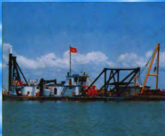
Tàu xén thổi 4170 CV nạo vét ở vùng biển Nghi Sơn - Thanh Hóa trong điều kiện biển thường xuyên có sóng gió cấp 4, địa chất công trình là cát nền, phun xa 2500m.
